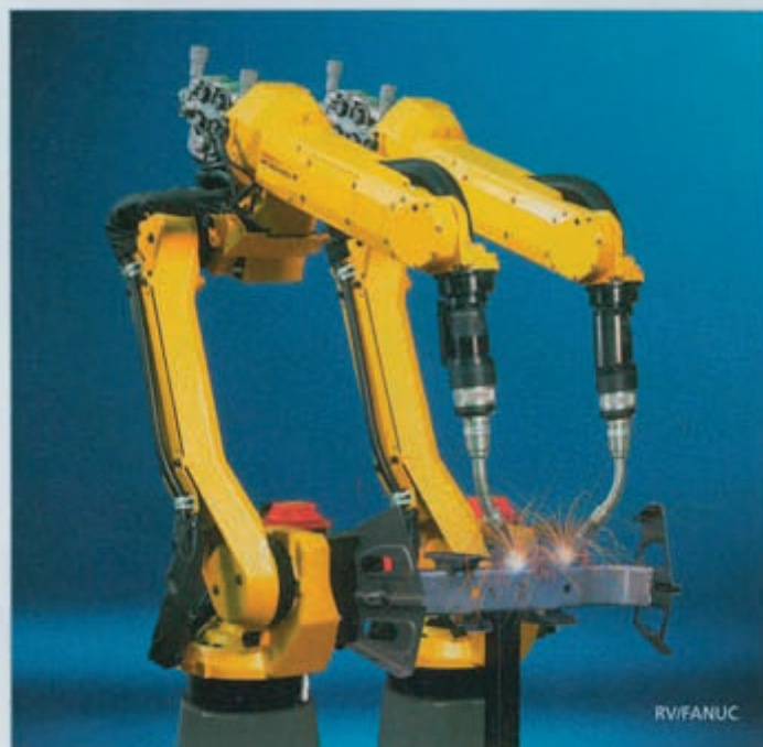
De ARC Mate 100iC van Fanuc Robotics: de voetprint van de lasrobot is zo smal dat meerdere lasrobots makkelijk naast elkaar kunnen werken.
